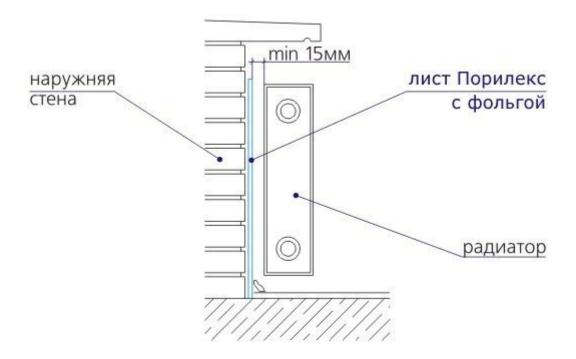
При установке теплоизоляционного экрана лучше располагать его ближе к поверхности стены, а не к поверхности батареи. Можно прикрепить его к стене с помощью обычного двустороннего скотча, или с помощью степлера – к деревянной рейке. Размер экрана должен несколько превосходить проекцию прибора на участок стены.
